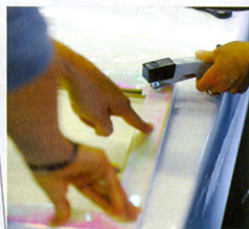
5 Überstand nach innen auf Rahmen falten, Ecken einschneiden. Wie ein Paket falten und mit Tacker fixieren
